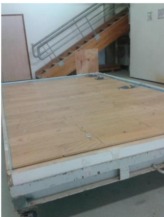
Photos 1 : Maquettes de parquet sur sol chauffant hydraulique et électrique
